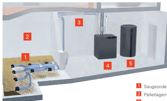
Lagerraum ohne Schrägboden mit Zuführung zum Pelletkessel über Saugsonden
