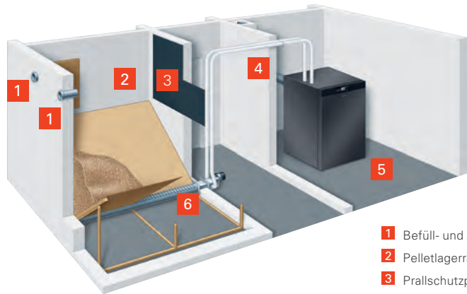
Einbaubeispiel Lagerraum mit Zuführung zum Pelletkessel durch Vakuum-Saugsystem
